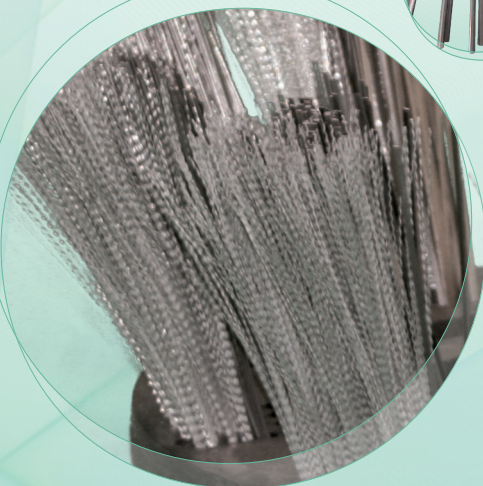
Garnissage mixte : acier frisé + acier méplat
